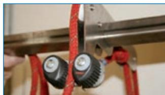
Il sistema autobloccante permette ad una persona sola l'installazione in sicurezza del sistema nebbiogeno.
